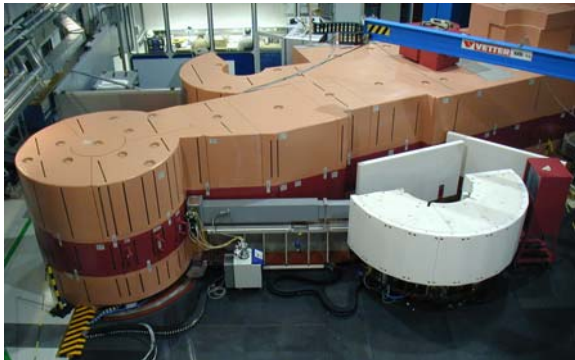
Abb. 1: Blick auf das Strukturpulverdiffraktometer SPODI
